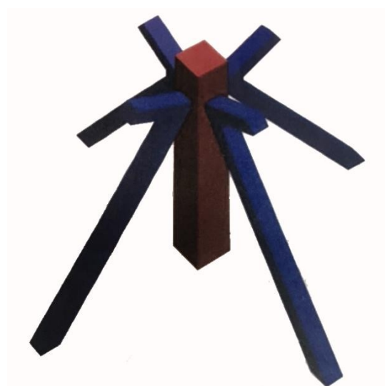
图5.3-4 斜撑组合牡蛎礁示意图
