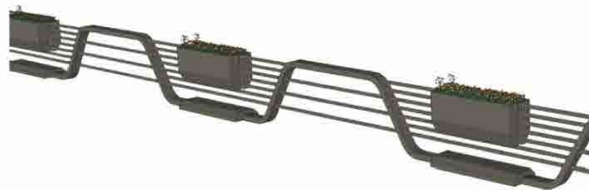
中央隔离护栏（标准段）透视图
