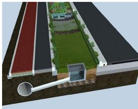
人行道、非机动车道及广场、庭院铺装部分部分采用透水铺装地面，硬化地面中透水铺装率不低于 40%，外排雨水流量径流系数不大于 0.6。
